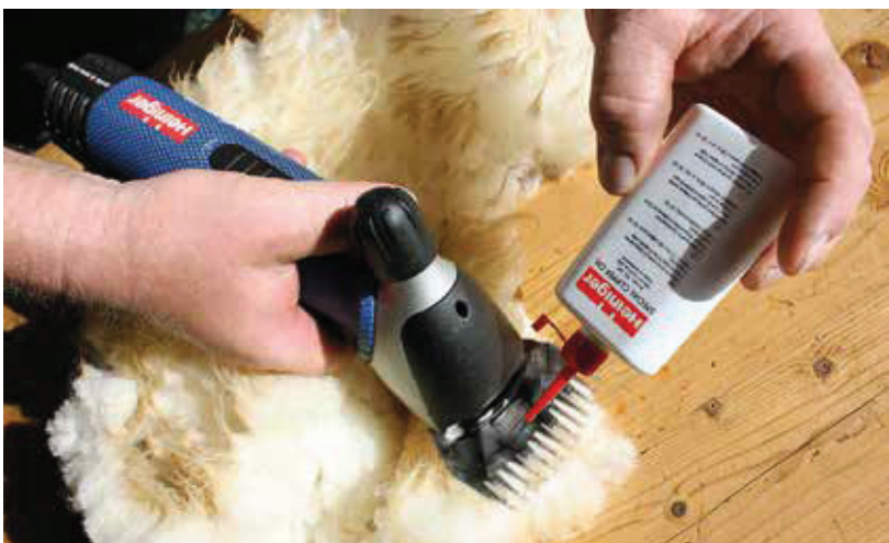
Das regelmäßige Ölen des Scherkopfes während der Schur erleichtert das Scheren und verhindert zu starke Abnutzung.
